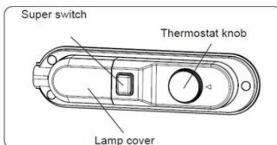
Termostat automatski reguliše temperaturu unutar frižidera i zamrzivača. Hladnije temperature se mogu dobiti okretanjem dugmeta na veće brojeve, 1 do 5.
